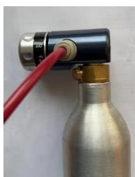
Pe langa apa rece si apa calda, dozatoarele pot produce si apa carbogazoasa. Pentru realizarea acesteia, dozatoarele utilizeaza butelii cu CO2 care sunt conectate prin intermediul unui tub  $\frac{1}{4}$ ".
